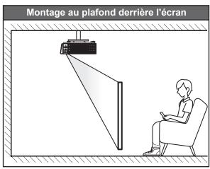
Le projecteur doit être placé à plat sur une surface et à 90 degrés / perpendiculairement à l'écran.
