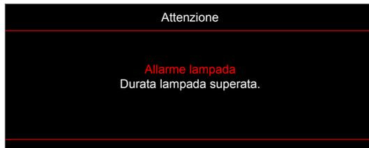
Quando si vede questo messaggio, mettersi in contatto con il rivenditore oppure con il Centro assistenza per sostituire al più presto la lampada. Assicurarsi che il proiettore si sia raffreddato per almeno 30 minuti prima di cambiare la lampada.
