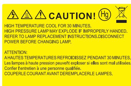
تحذير: يرجى توخي الحذر عند فتح لوحة الوصول إلى اللمة إذا كان جهاز العرض مثبتاً بالسقف، كما يوصى بارتداء نظارات الحماية عند استبدال اللمة، متى كان الجهاز مركباً بالسقف. يرجى اتخاذ الاحتياطات الضرورية لمنع سقوط أي أجزاء غير محكمة الرابط من الجهاز.
