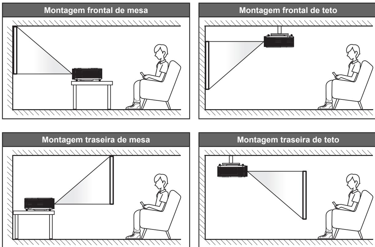
O projetor deve ser colocado em uma superfície plana e 90 graus/perpendiculares à tela.
