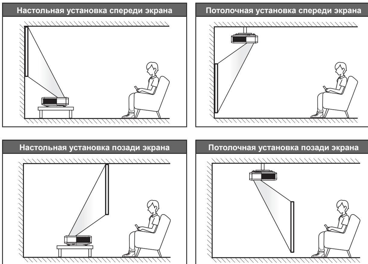
Проектор устанавливается на плоской поверхности и перпендикулярно экрану.
