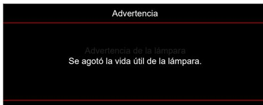
Cuando aparezca este mensaje, por favor contacte con su proveedor local o el centro de servicio para sustituir la bombilla lo antes posible. Antes de sustituir la bombilla, asegúrese de que apaga el proyector, desconecta el cable de alimentación y cerciórese de que el proyector se ha enfriado durante al menos 30 minutos y la bombilla se ha enfriado completamente.
