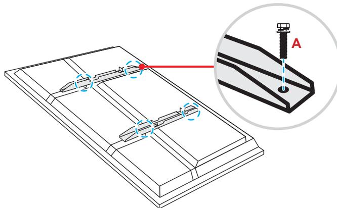
**Nota:** Los soportes dobles de montaje, el soporte para pared y los tornillos (A) se incluyen en el kit de instalación en pared. Consulte la sección "Instalación en la pared" en la página 14.
