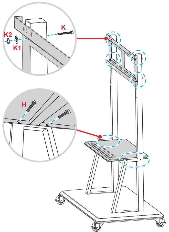
7. Alinee y enganche los soportes dobles de montaje en el soporte para pared instalado en los postes del pedestal.
