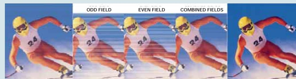
Herkömmliches Interlaced Video sendet gerade und ungerade Zeilen separat um bei höherer Auflösung mit einer niedrigen Bandbreite auszukommen.
